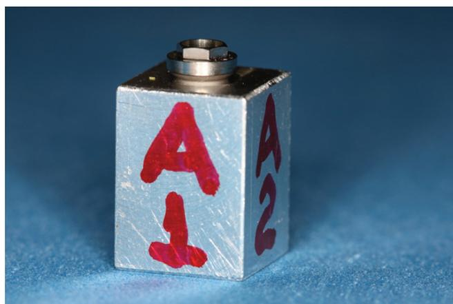
Figura 1. Matriz metálica com implante posicionado.
