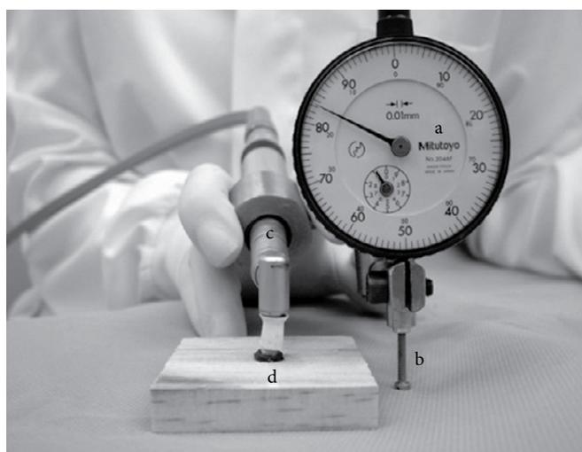
**Figura 2.** Padronizador de pressão. a) relógio comparador; b) haste controladora de pressão; c) micromotor; d) espécime.
