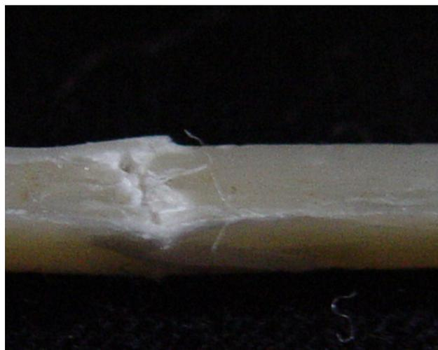
**Figura 7.** Fratura incompleta observada na fibra de vidro unidirecional Fibrex Medial® (Angelus).
