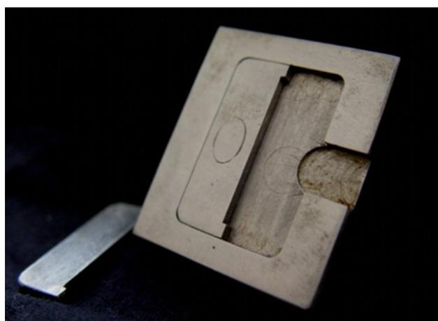
**Figura 1.** Vista superior da matriz metálica para confecção dos corpos-de-prova.
