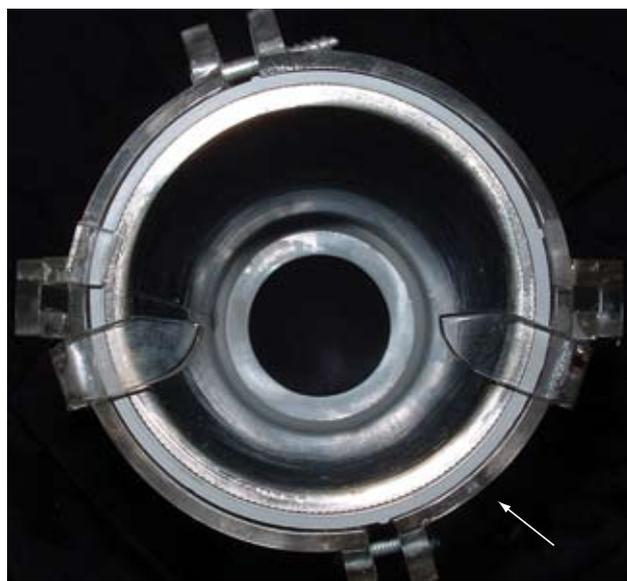
**Figura 1.** Visão frontal do sobrecilindro (seta) acoplado ao cilindro do aparelho de raios X.
