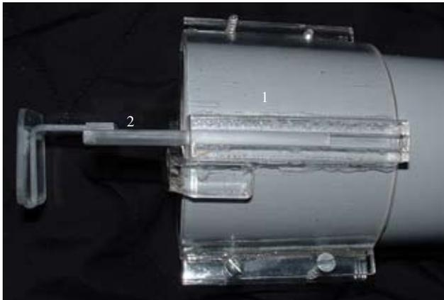
**Figura 2.** Visão lateral do sobrecilindro (1) e cilindro, com o posicionador (2) encaixado na canaleta.
