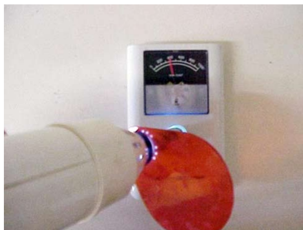
Figura 1. Ponta do fotopolimerizador centralizada e paralela à célula fotossensível do radiômetro.
