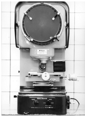
FIGURA 8 – Perfilômetro Nikon utilizado para a leitura do desajuste cervical.
