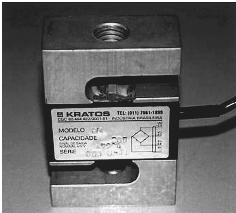
FIGURA 2 – Célula de carga número 008 usada para os ensaios de compressão axial.
