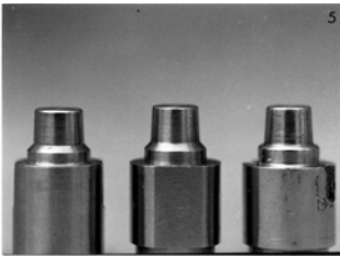
FIGURA 4 – Conjunto modelo-padrão e cápsula metálica: a) lateral do modelo-padrão aplainada para ser adaptada à mesa do metroscópio; b) elevação hemisferoidal com 1 mm de diâmetro na parede externa da cápsula metálica.
