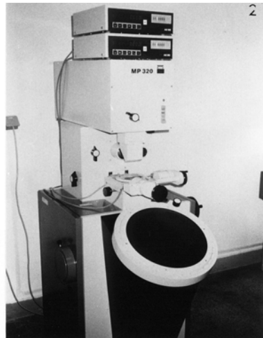
FIGURA 1 – Aparelho para aplicação de carga de assentamento de 5 kg atuando sobre o conjunto cápsula metálica e modelo-padrão.
