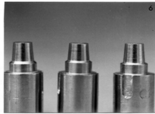
FIGURA 4 – Conjunto modelo-padrão e cápsula metálica: a) lateral do modelo-padrão aplainada para ser adaptada à mesa do metroscópio; b) elevação hemisferoidal com 1 mm de diâmetro na parede externa da cápsula metálica.
