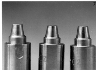
FIGURA 5 – Corpos-de-prova com 6° de conicidade e términos cervicais em: a) plano inclinado em 135°; b) chanfro; c) ombro reto com bisel a 45°.
