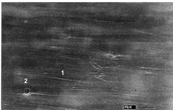
FIGURA 16 – Cerâmica pós-polimento, com evidência dos sulcos (1) e poros (2). 1.000x.
