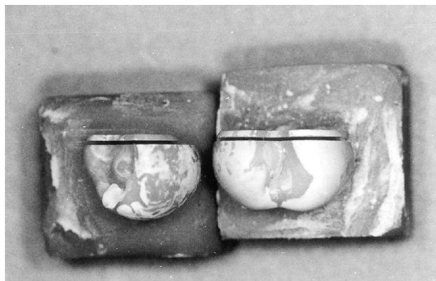
FIGURA 1 – Espécimes que receberam os tratamentos propostos pelo trabalho, no momento de sua secção no sentido vestibulo-lingual, com auxílio da cortadeira metalográfica Isomet 2000 – BUEHLER (visão oclusal).
