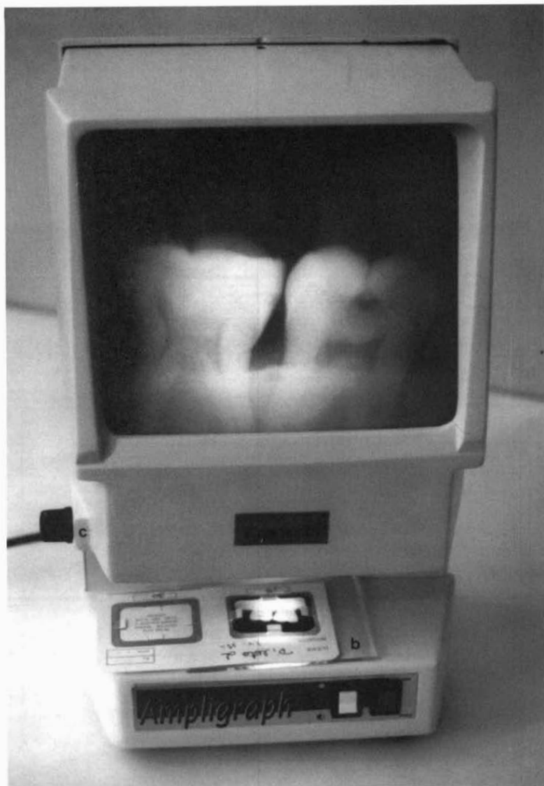
FIGURA 1 – Aparelho Ampligraph que promove o aumento da imagem radiográfica em 5,4 vezes.
