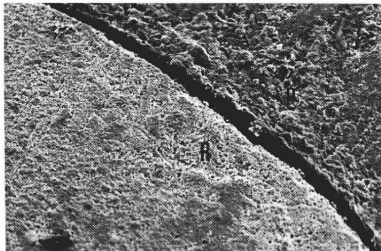
FIGURA 2 - G2 - Interface sistema adesivo dentinário e resina composta (R) - preparo cavitário (P). Fenda marginal medindo 10 \mu\text{m} . Fotomicrografia em MEV (500x).
