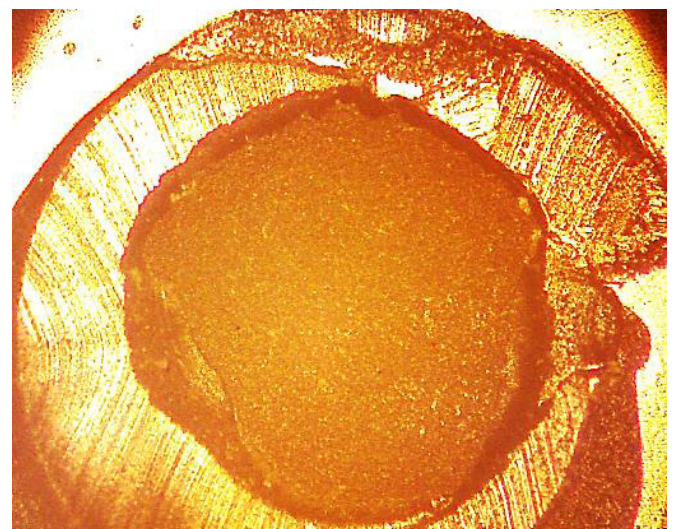
Figura 2. Fratura do tipo Coesiva em cerâmica.
